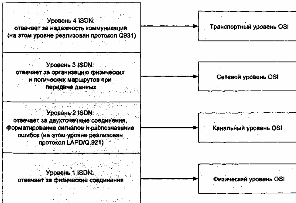
Рис. 7.11. Многоуровневые коммуникации ISDN в сравнении с эталонной моделью OSI
